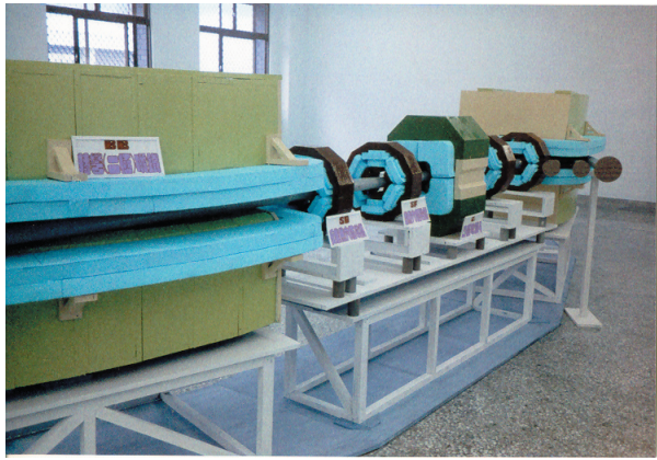
圖八：原尺寸大的六分之一段貯存環模型。
