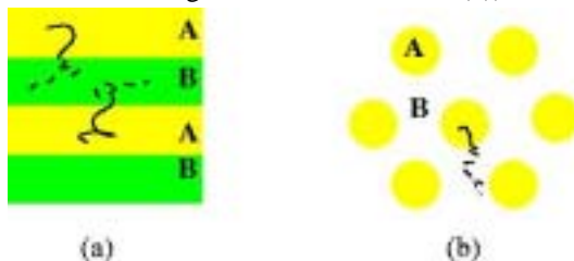
圖一：(a)線性 AB 塊狀共聚物的層狀結構；(b)圓柱狀結構。
