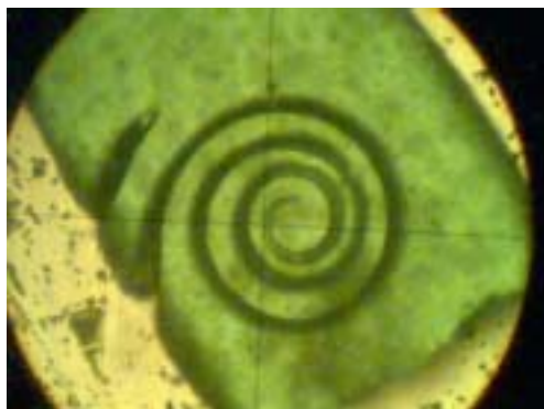
圖五、磷化鎳 [Ni_3(PO_4)_2] 沈澱物龜裂後，在其中一塊碎片中所見、約 1mm 大小的螺旋裂痕。
