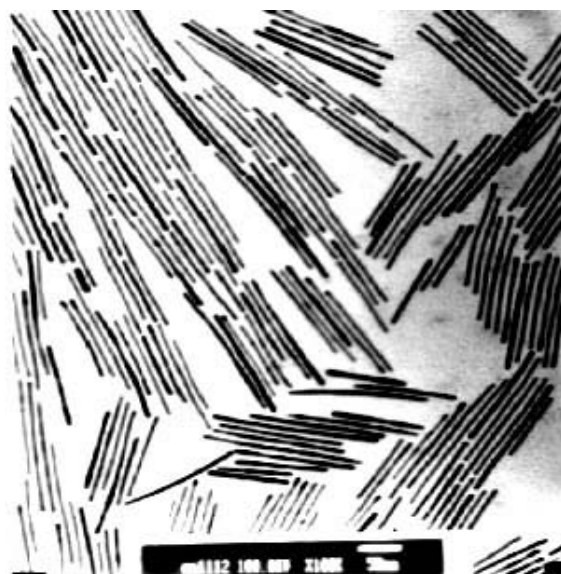
圖十一：電化學法所得之棒狀金屬奈米顆粒電子顯微鏡照片（取材自參考文獻十八）。
