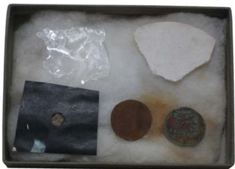
圖二 此盒子內的內容，以綿花做底上放着(1)雲母片，(2)瀘紙，(3)黑的紙中間有洞，黑紙後面貼着固定線源的厚(紙)臺中間固定圓板的線源，黑紙有小圓洞，使線源的表面射出的 \alpha 粒子不被阻擋。(4)兩枚小銅(?)板，也是固定Po所用。
