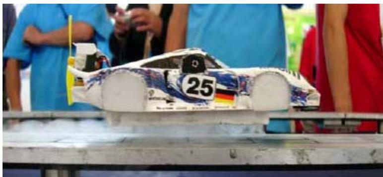
圖九、高溫超導磁浮列車模型。
