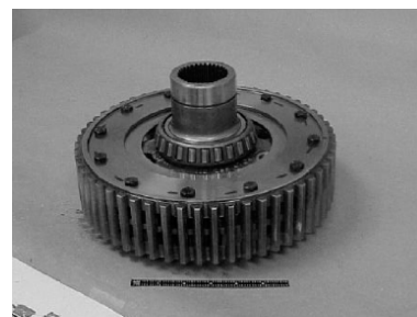
圖 18 美國西南研究所將 PIII 技術應用大於戰車軸承元件耐磨處理[39]
